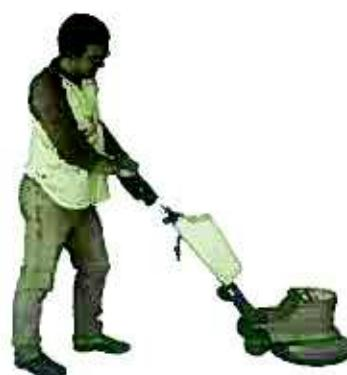
nebo dolu. Při používání stroje se musí obsluha postarat, aby se prodlužovací kabel nedostal do přítomnosti kartáče.
