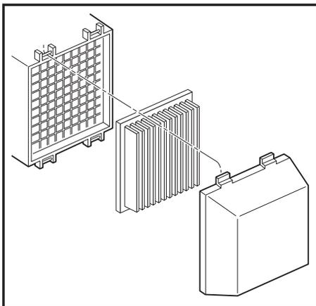
**cs** Čištění vzduchového filtru. Odstraňte víčko a filtrační vložku. Jestliže je vzduchový filtr znečištěný, nemůže motor správně fungovat a může se poškodit. Vzduchový filtr vyměňte každý rok, nebo častěji, pokud sekáte ve velmi znečištěném a prašném prostředí. Viz návod k motoru. (Přečtěte si příložené pokyny k obsluze motoru.)
